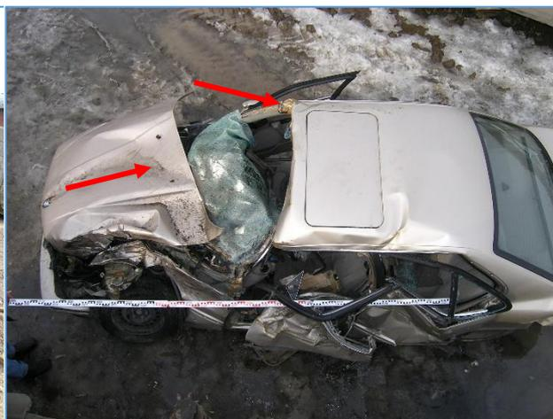
Фото 92 На капоте имеются следы перемещения слеодообразующего объекта, а на рамке ветрового стекла и панели крыши и правой стойки деформация с вытяжкой металла и следами утыкания
