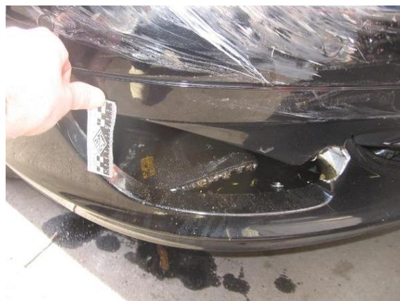
Фото 131, 132. Детализовка повреждений в верхней и нижней передней правой части автомобиля
