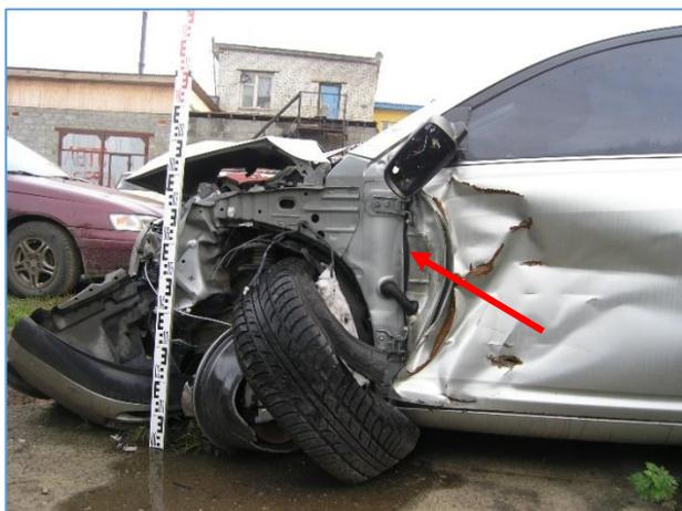
Фото 87 На автомобиле отсутствует левое переднее крыло и имеются следы его отрыва
