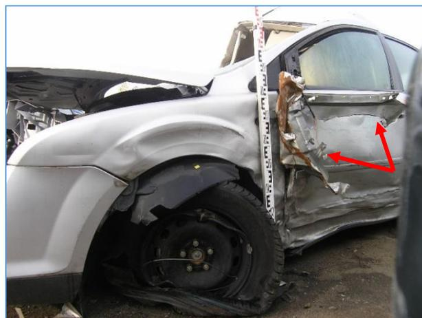
Фото 88 В элементах конструкции автомобиля зажато деформированное крыло другого автомобиля
