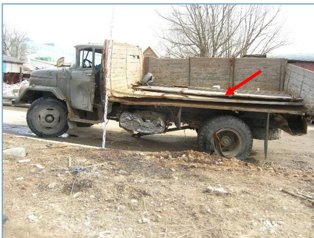
Фото 91 Левый борт автомобиля ЗИЛ полностью отделен и располагается на грузовой платформе
