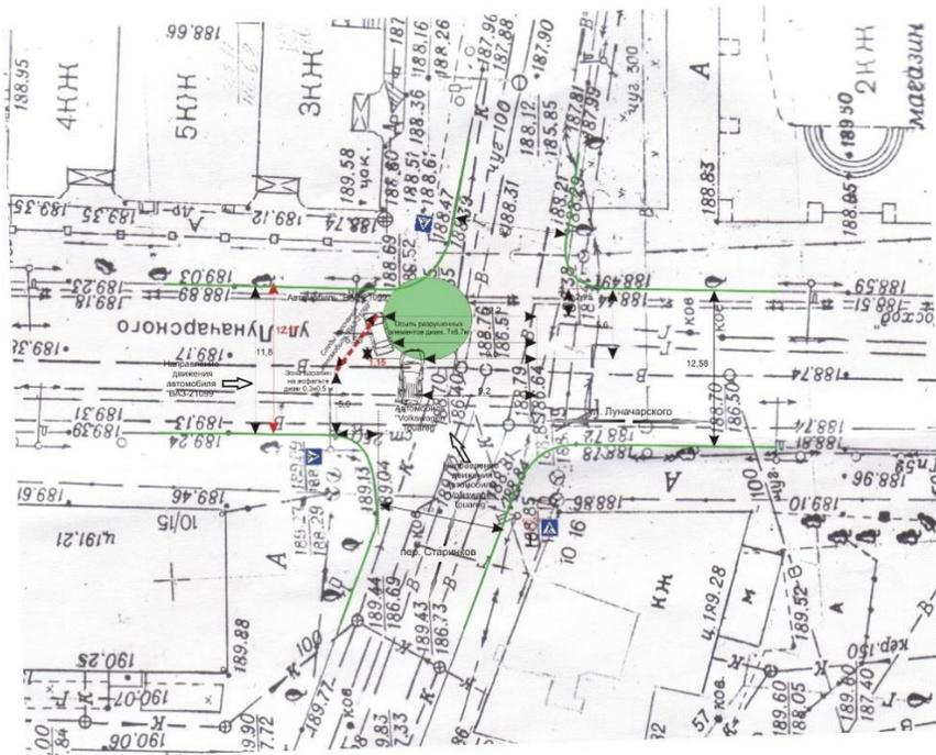
Иллюстрация 59 Выкопировка перекрестка с нанесенными контурными линиями края дороги
